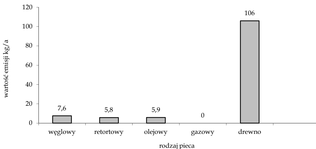
Rysunek 16. Porównanie emisji pyłu w zależności od rodzaju ogrzewania (pieca)
